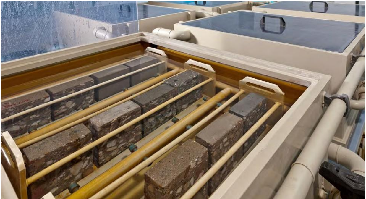
Abbildung 3 Prüfanlage zur Einlagerung der Probekörper in Säure
